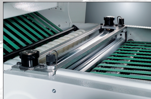
Integrierte Pressstation serienmäßig mit Vor- u. Hauptpresswalzen
