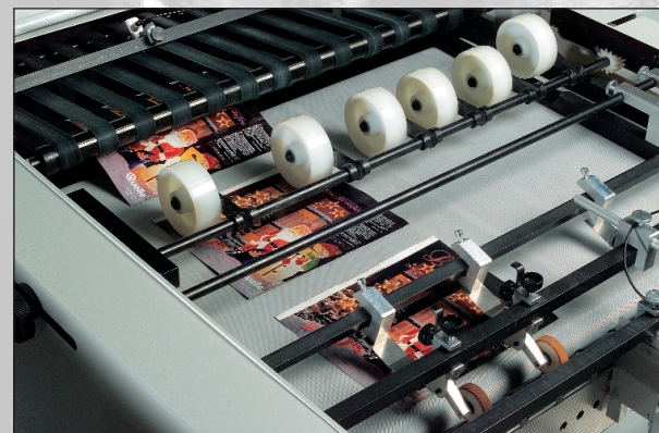
Neben Produkttransport im Schuppenstrom ist markierungsfreies Auslegen durch Einzeltransport möglich
